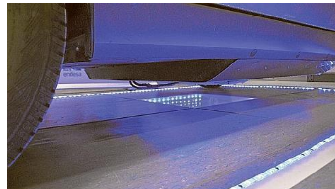
Detalle del alojamiento subterráneo de las bobinas en el Proyecto Victoria de Endesa
