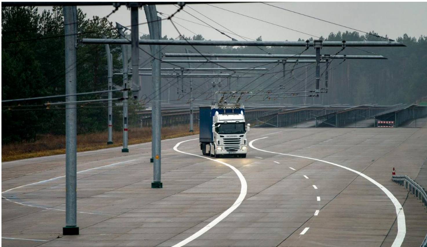
PANTÓGRAFO EN LA INFRAESTRUCTURA VIARIA. PROYECTO SCANIA-SIEMENS E-HIGHWAY
