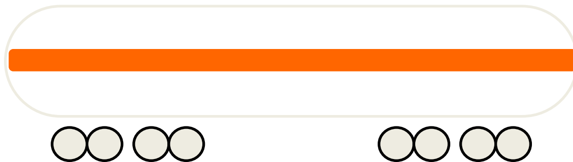
Banda naranja de 30 cm de alto para gases licuados refrigerados o disueltos
